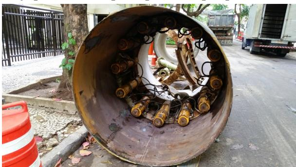
à linha de cravação, e é composta de cilindros hidráulicos, que devem ser acionados desde a superfície pelo sistema hidráulico da máquina, requerendo a instalação de inúmeras mangueiras e muito extensas. Essa decisão exige um planejamento extensivo de forma a garantir o funcionamento contínuo e total da escavação e cravação.
